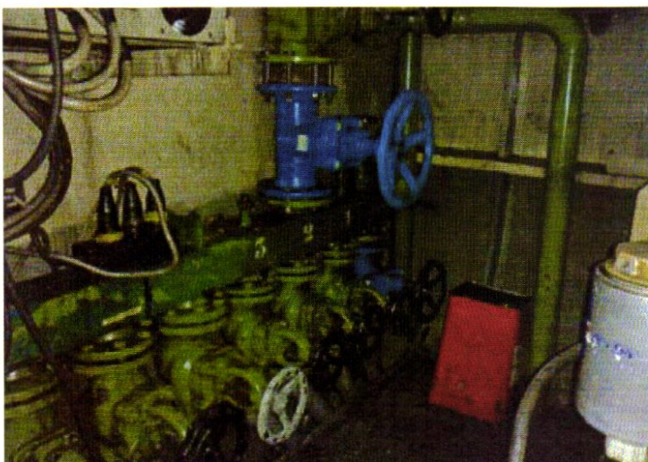
Een ballast/lensstelsel met lage aanzuig in de kim.
